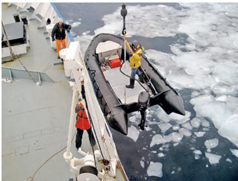
Небольшая надувная лодка используется для того, чтобы помочь извлечь пришвартованный приборный массив во время научной экспедиции (фото: Терри Уитледж, Университет Аляски) / A small inflatable boat is used to help recover a moored instrument array during the research expedition (photo: Terry Whitledge, University of Alaska)
